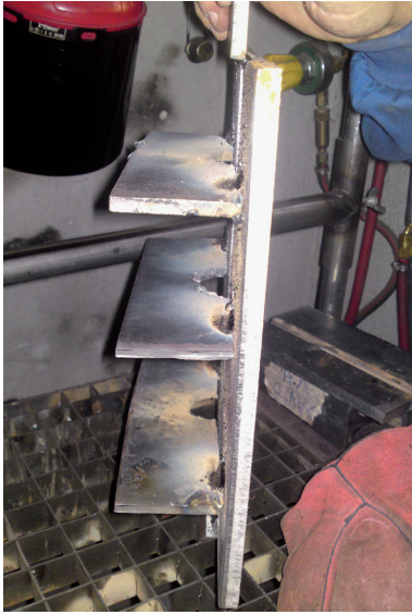
Soldadura PF en acero al carbono con electrodo básico 7018 embridada con "puentes"
