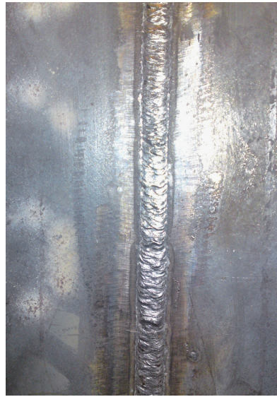
Soldadura PF en acero al carbono con electrodo básico 7018 embridada con "puentes"
