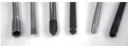
**Fig. 14** Diferentes tipos de puntas de destornillador
